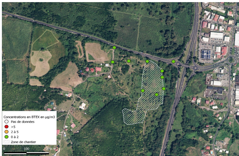
Fig 3. Cartographie des concentrations moyennes en benzène ( \mu\text{g}/\text{m}^3 ) sur la zone de Maupeou lors des 4 campagnes du 09/01/2020 au 02/12/2020
